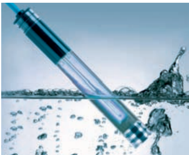
Das UV-Lichtsystem PURITEC® entkeimt Trinkwasser wirtschaftlich und ganz ohne Chemie. Das Gerät sendet Ultraviolettstrahlen in einer Wellenlänge aus, die Bakterien und Viren abtötet.
