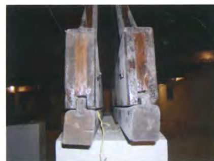
Fig. 6.15 e Fig. 6.16 – Macchina posta su binari di legno utilizzata per la traslazione orizzontale dei piani che costituiscono le quinte scenografiche. Posizione: nei locali sottostanti il palcoscenico del Teatro di Arcevia (AN).
