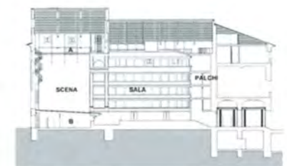
Fig. 3.10 – Collocazione tipica delle principali macchine da scena. A) graticcio; B) sottopalco.
