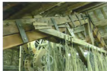
Fig. 6.27 – Corde per la movimentazione delle scene del Teatro Persiani di Recanati (MC).
