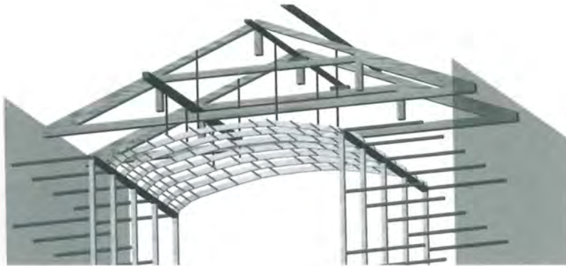
Fig. 3.3 – Esempio di sottostruttura inserita per sorreggere il plafone. Teatro Serpente Aureo di Offida (AP).
