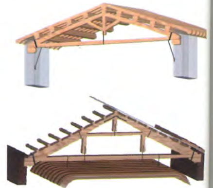
Fig. 4.68 – Esempi di capriata semplice (sopra) e composta (sotto).
