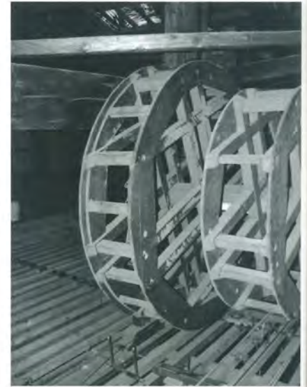
Fig. 3.11 - Teatro Pergolesi di Jesi (AN). Macchina utilizzata per la movimentazione verticale dei drappaggi e delle scene. Posizione: in appoggio sopra al graticcio.
