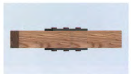
Fig. 4.97 e Fig. 4.98 - Esempi schematici di unione a dentatura obliqua con bietta e chivarde (sopra) e di unione dritta semplice con piastre di metallo collegate con chivarde (sotto).
