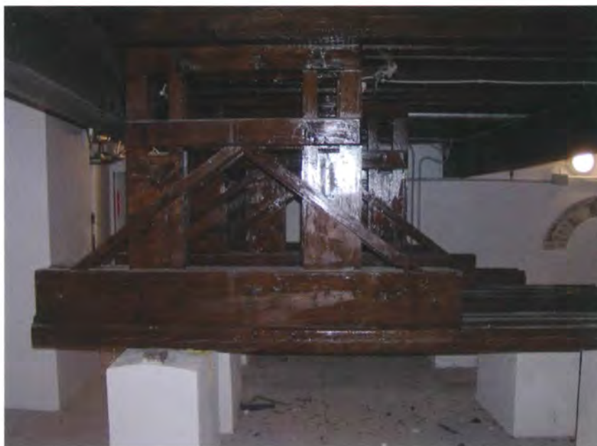
Fig. 6.15 e Fig. 6.16 – Macchina posta su binari di legno utilizzata per la traslazione orizzontale dei piani che costituiscono le quinte scenografiche. Posizione: nei locali sottostanti il palcoscenico del Teatro di Arcevia (AN).
