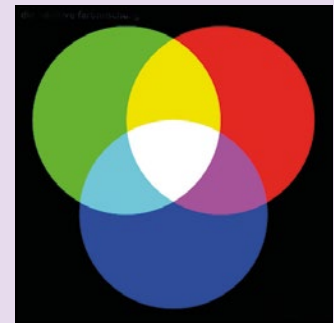
Das Prinzip der additiven Farbmischung im Auflicht: Die Grundfarben sind Rot, Grün und Blau (RGB). Nach der Formel L_{res} = L_1 + L_2 + L_3 ergeben alle drei Farben Weiß.
