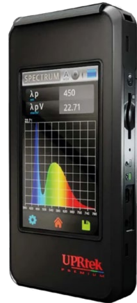
Abb.3 Das Messgerät (Volksoper und Burgtheater): Spektrometer MK 3505 Premium UPRtek
