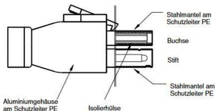
Der Bühnenhängestecker wird für Verlängerungskabel und Scheinwerferanschlüsse mit Kabel verwendet.
