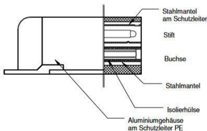
Die Anbaudose wird einerseits als Anschlußdose und an Scheinwerfern als Anschlußstecker verwendet.
