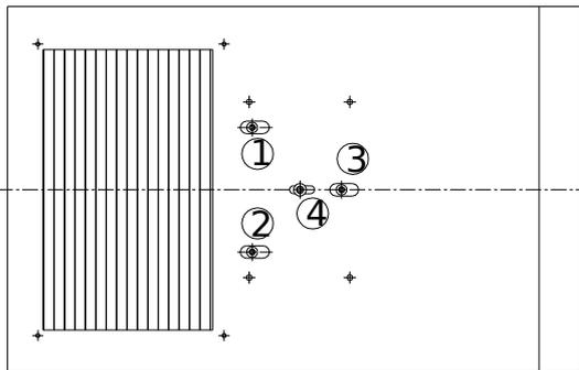
Justierung der Schrauben (1) (2) (3) mit Inbusschlüssel Nr. 4 (im Lieferumfang enthalten)
