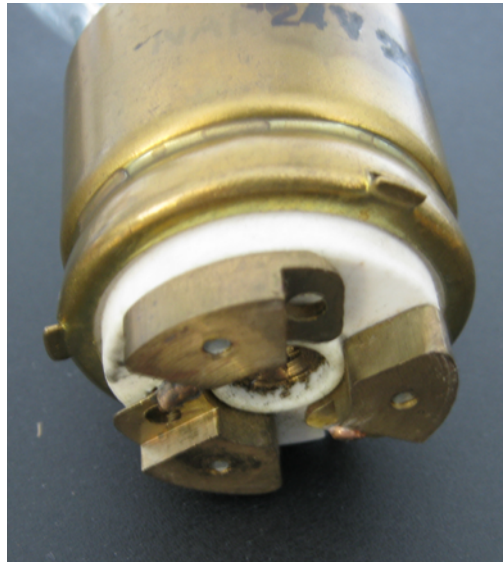
Bild 39: Kuppenverspiegelte Lampe 24 V / 250 W
