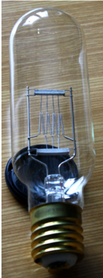
Bild 34: K-Lampe: 1000 Watt, 220 Volt, E 40, 23000 lm; Länge 235 mm, D= 65 mm
