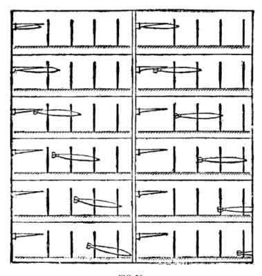
TORPEDO BADLY FIRED. TORPEDO PROPERLY FIRED.
