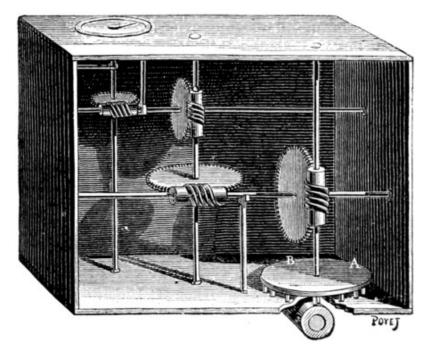
FIG. 1.—HERON'S ODOMETER FOR VEHICLES.
