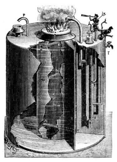
FIG. 4.—HERON'S TUBULAR BOILER.
